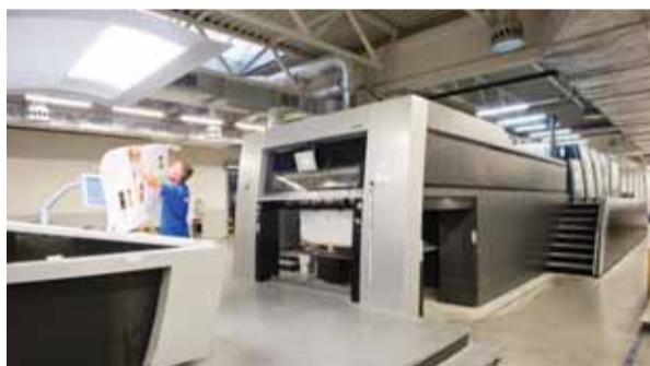
Do novej budovy Neografia pri jej postavení nainštalovala aj dovtedy najvýkonnejší hárkový tlačový stroj Heidelberg Speedmaster XL 145.
